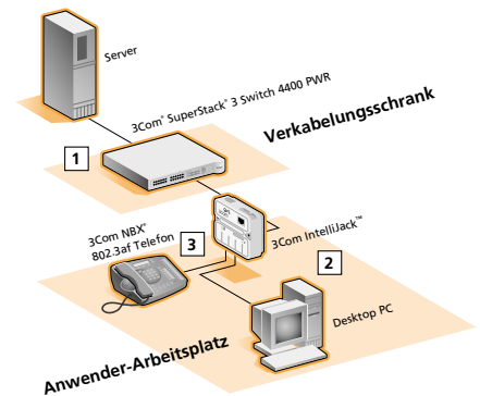
Abb. 3: 802.3af-kompatible Power over Ethernet Netzwerkconfiguration mit Stromweiterleitung zu einem anderen Gerät.
